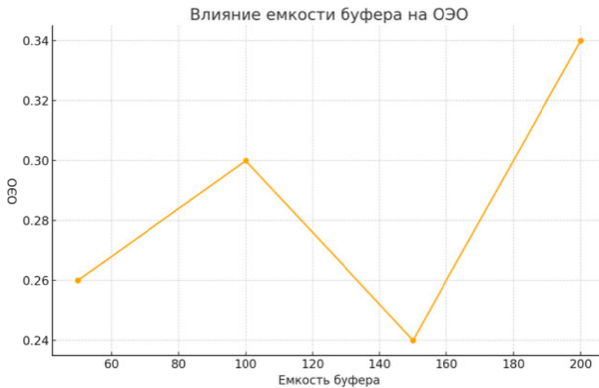
Рис. 3. Полученная в ходе имитационного моделирования зависимость влияния емкости буфера на коэффициент ОЭО
