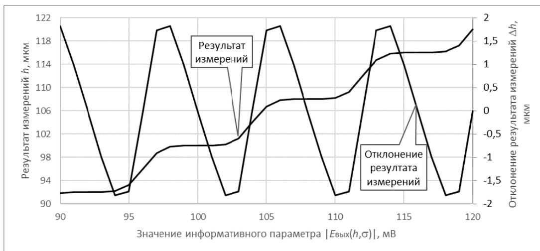
Рис. 9. Зависимость результата измерений  $h$  и отклонения результата измерений  $\Delta h$  от значения информативного параметра  $|\dot{E}_{\text{вых}}(h, \sigma)|$
