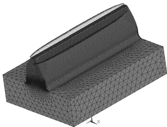
Рис. 2. Расчетная схема нагружения прямого зуба без перекоса
