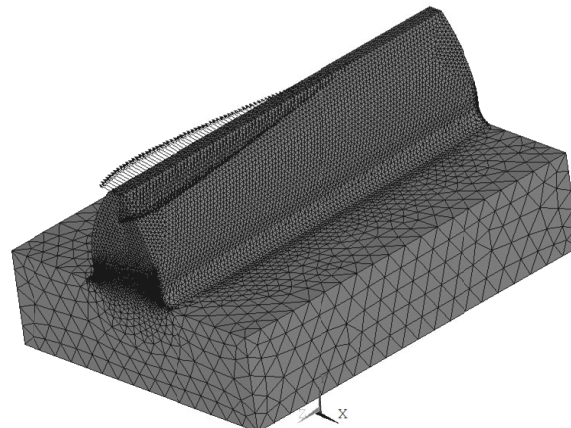
Рис. 3. Расчетная схема нагружения прямого зуба при перекосе 8 минут
