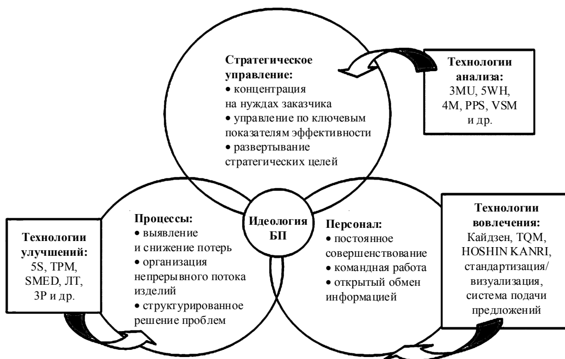
Рис. 3. Систематизация инструментов и методов бережливого производства
