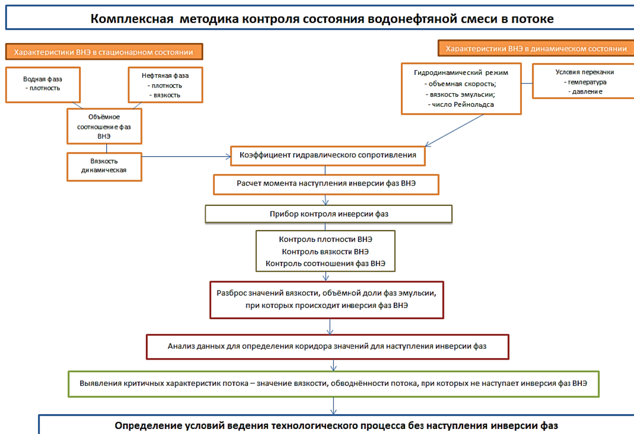
Рис. 3. Комплексная методика контроля состояния водонефтяной смеси в потоке
