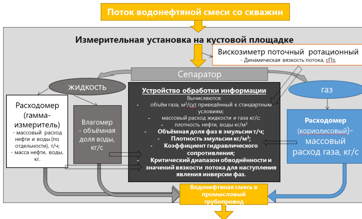
Рис. 2. Модернизированная схема контроля характеристик водонефтяного потока на объектах добычи нефти и газа
