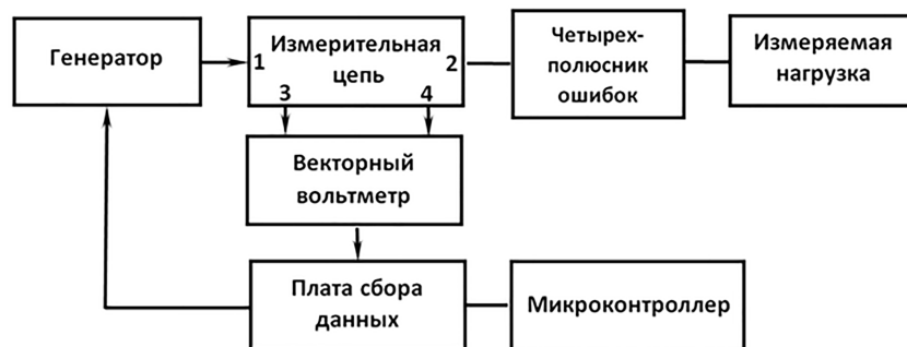
Рис. 4. Структурная схема измерителя на основе векторного вольтметра
