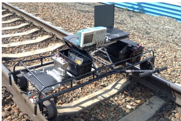
Рис. 1. Внешний вид установки для контроля продольных напряжений в рельсах с использованием эффекта акустоупругости
