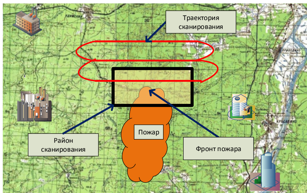
Рис. 2. Определение района сканирования, координат и границ фронта пожара
