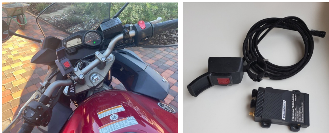
Рис. 2. Внешний вид тестового устройства с реализацией алгоритма комплексирования одометра, гироскопа и акселерометра
